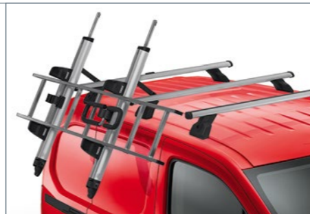
Držiak sklopného rebrika – preklopená poloha
